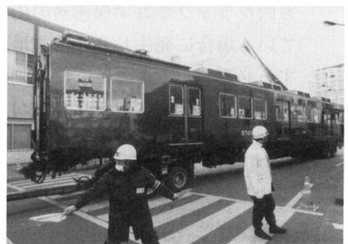
写真-V.8.4 道路上を輸送される車両
